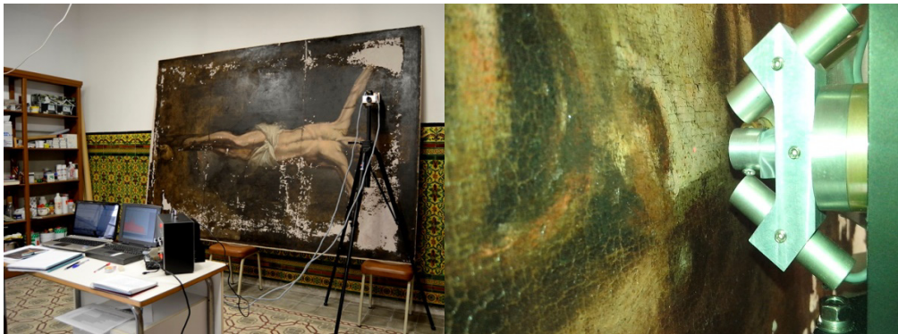
Figura 5. Izquierda: Análisis in situ con XRF. Derecha: Detalle del análisis XRF con uno de los puntos seleccionados (la nariz de Cristo).
