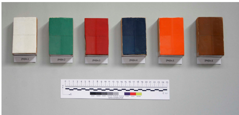
Figura 2. Probetas que reproducen la policromía del alfarje a partir de los materiales identificados.
