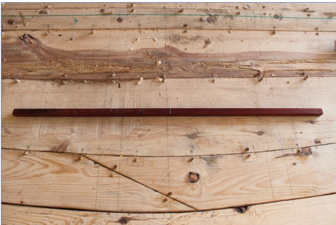
Figura 2. Regla maestra de trazado de líneas de agua y proporciones de formas y elementos constructivos. Descrita anteriormente.
