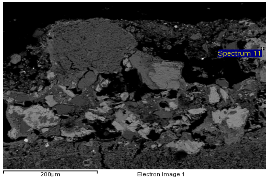
Figura 2. Imagen en electrones retrodispersados de la capa de azul egipcio de la Figura 1.
