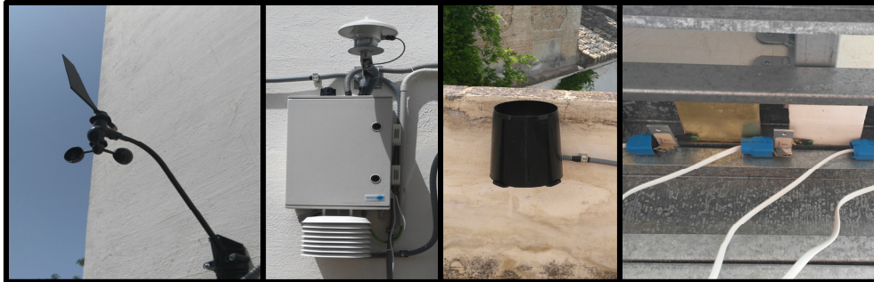
Figura 3. Equipo de sensores que conforma la estación meteorológica.
