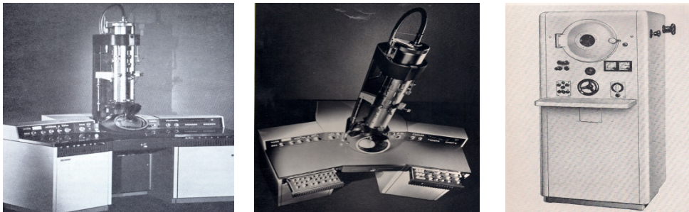
Figura 1. Microscopio de transmisión Philips EM-300 y equipo de vaporización de carbón
