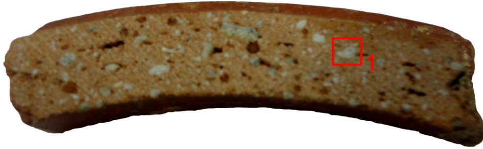
Figura 5: Sección transversal de la pieza 7. Pueden observarse las partículas finas del aditivo primario. Existen marcadas diferencias entre las granulometrías de las partículas de aditivo y la matriz arcillosa de color claro. 1: Partícula primaria fina.
